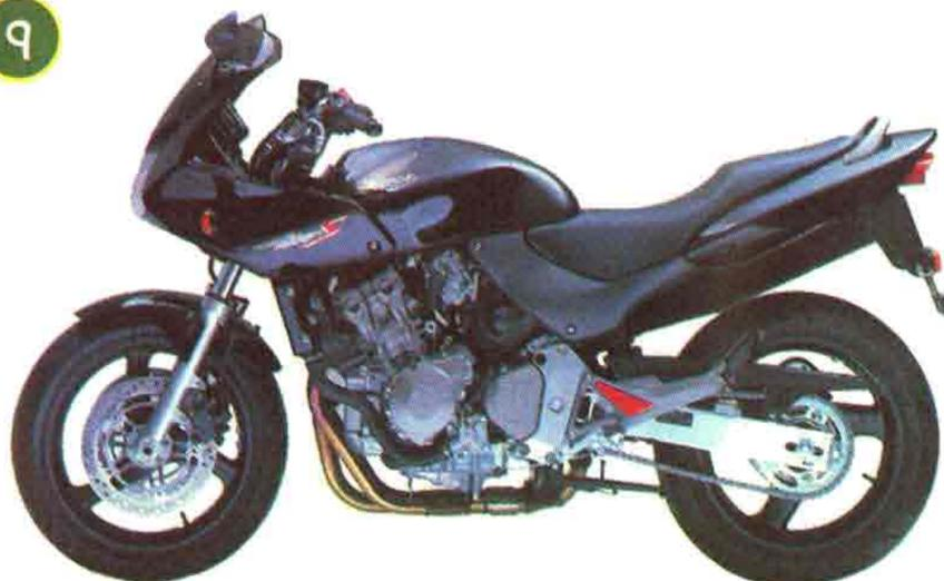
قبل از عرضه این موتورسیکلت، هورنت ۲۵۰ تنها برای استفاده در ژاپن ساخته شده بود. این موتورسیکلت ۶ دنده است، ۴ کاربراتور تخت دارد که به صورت دیجیتالی کنترل سوخت و هوا را برعهده دارند. ۴ سیلندر با پوشش سرامیک و آلومینیومی نیز از مشخصات دیگر این وسیله است.
