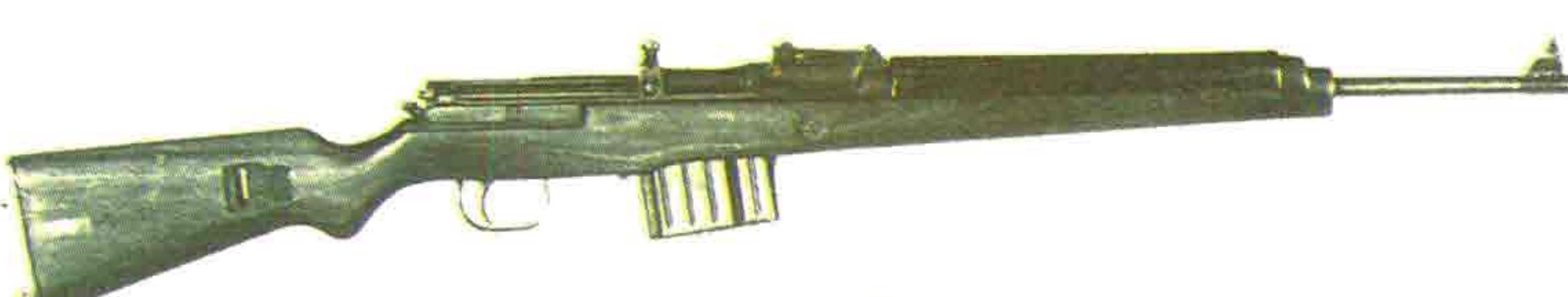
این تفنگ کالیبری برابر هفت و نه دهم میلی‌متر دارد. طول آن یک متر و ۱۷ سانتی‌متر است و وزن آن ۴ کیلو و چهارصد گرم است. ۱۰ فشنگ در خشاب تفنگ جای می‌گیرد.
